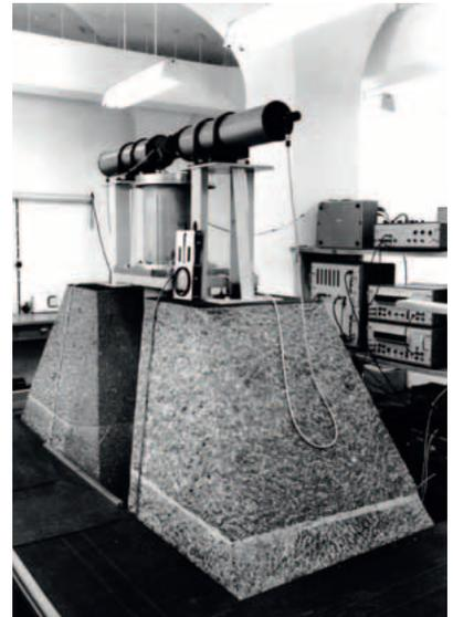
Abb. 11 Quarzpendelgerät auf dem Pfeiler S12 im NO-Keller (Aufnahme: L. Hannemann)
