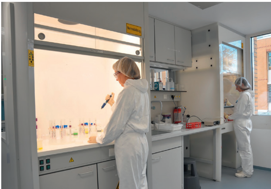
Abb. 3: Vorbereitung der Isotopenmessungen durch TIMS oder MC-ICP-MS durch kontaminationsfreie Separation der winzigen Mengen der Elemente von Interesse in hochreinen Chemielaboratorien (hier: „HELGES – Helmholtz Laboratory for the Geochemistry of the Earth Surface“ des GFZ; Foto: E. Gantz, GFZ)
