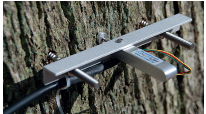
Abb. 6: Punktdendrometer, hier installiert an einer Eiche, messen ununterbrochen seit 2012 halbstündig das Dickenwachstum von 36 Bäumen im Müritz-Nationalpark. (Foto: I. Heinrich, GFZ)
