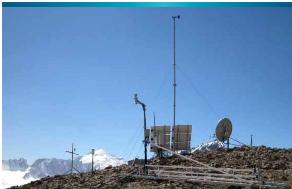
Метеорологическая и гляциологическая мониторинговая станция, установленная на леднике Абрамова в 2011 г. в рамках проекта CAWa.
