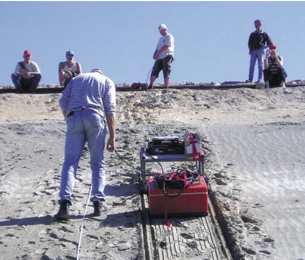
Bodenradar-Untersuchungen auf einem Sanddamm
