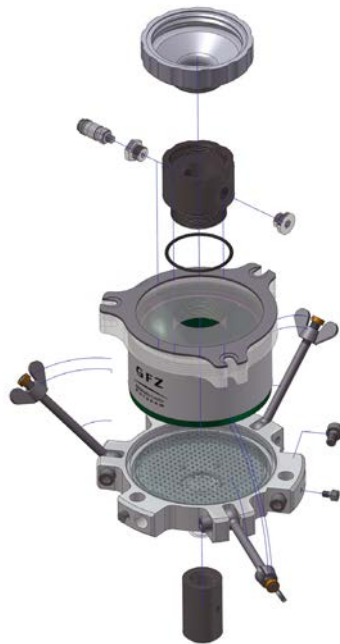
Die Explosionszeichnung des Filters zeigt den Zusammenhang der einzelnen Bauteile. Bild: M. Reich
