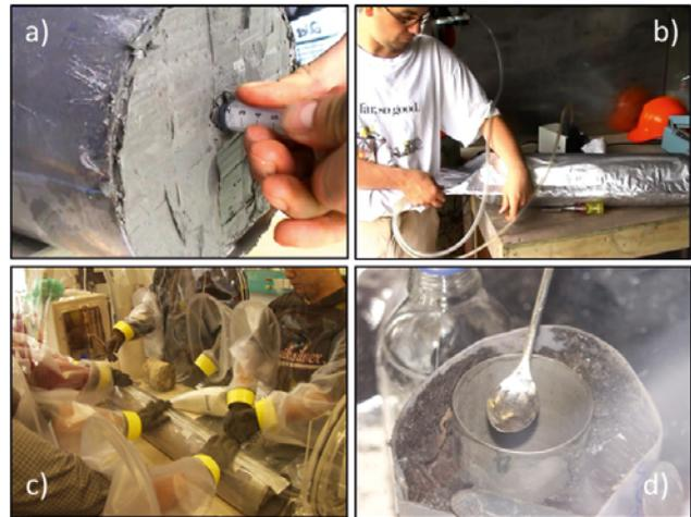
Abb. 4: Entnahme von Probenmaterial für die Untersuchung tiefer mikrobieller Ökosysteme: a) Entnahme von Unterproben zur Bestimmung der Eindringtiefe der Bohrspülung, b) Einschweißen der Kerne in eine Kunststoffolie und Entnahme von Sauerstoff sowie Begasung mit Stickstoff, c) Probenahme in einer Probenahmebox unter Stickstoffatmosphäre und d) Probeentnahme aus dem inneren Bereich des Kerns („inner coring“) (Fotos: K. Mangelsdorf, GFZ)
