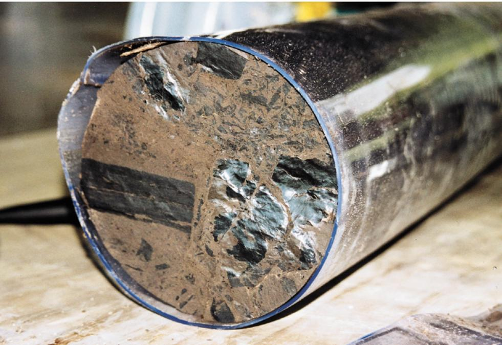
Abb. 1: Kern aus der DEBITS-1 Bohrung (Nordinsel Neuseeland) mit Kohlefragmenten als Beispiel für eine Tonablagerung, die reich an organischem Material ist. (Foto: K. Mangeldorf, GFZ)
