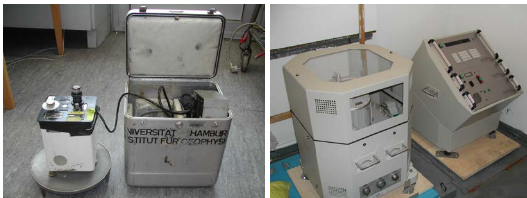
Abbildung 4.17: La-Coste-Romberg Gravimeter (links) und Seegravimeter (rechts) der Universität Hamburg (Foto: Dr. A. Dehghani).
