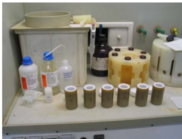
Abb. 4-22: Mikrowellengestützte Königwasserextraktion in Teflongefäßen (Foto: Kreschnak 2007)
