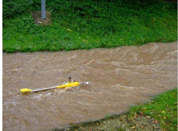
Abb. 4-50: Die Messung des Abflusses während eines Hochwasserereignisses trägt zur Verbesserung der Datenlage für das Niederschlag-Abfluss-Modell bei
