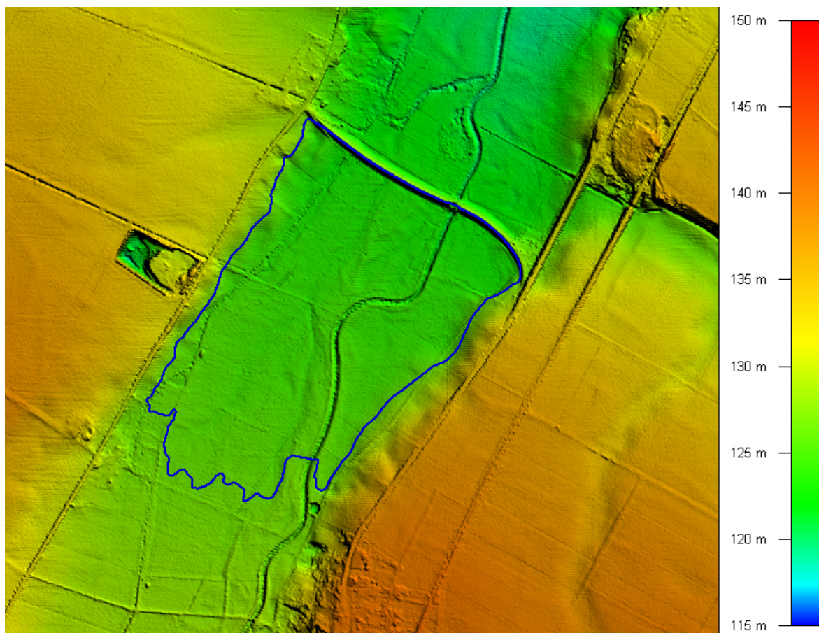
Abb. 6-2: Einfluss der Topographie des Beckenstandorts auf die Beckenform am Beispiel des HRB Horchheim / Erft (Blaue Linie entspricht Stauziel)
