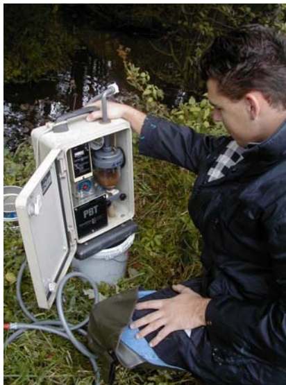
Abb. 4-46: Einsatz einer Vakuumpumpe (umgebauter Probenehmer) zur Sedimententnahme (Foto: Erftverband 2002)
