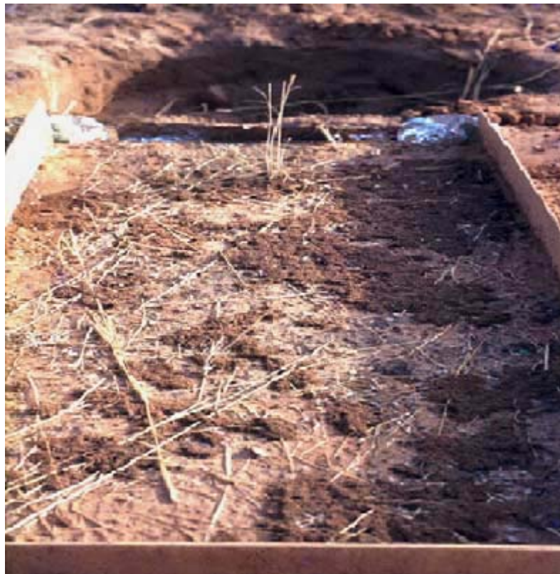
Abb. 4-6: Kleinparzelle (1 m 2 ) für Rillen- und Zwischenrillenerosion (Stroosnijder 2005, S. 166)
