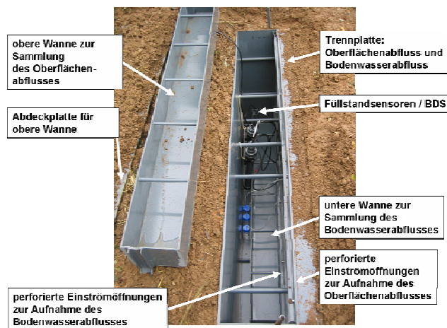
Abb. 4-43: Monitoringsystem zur Erfassung des Oberflächenabflusses und des Bodenwasserabflusses (BDS = Betriebsdatenerfassungssystem (Quelle: Kistemann et al. 2007).
