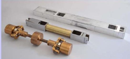
Historisches *Halbsekundenpendel* von 1898-1904, ein *Messingpendel* für das 25-cm-Reversionspendelgerät und ein *37,5-cm-Quarz-Pendel* für das Quarzpendelgerät von 1968-1969 (von links nach rechts)
