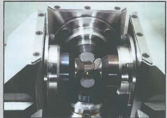
Hochdruckzelle, bestehend aus sechs Hartmetallstempeln (zwei sind entfernt), die den würfelförmigen Probenkörper (Kantenlänge 8mm) komprimiert.
