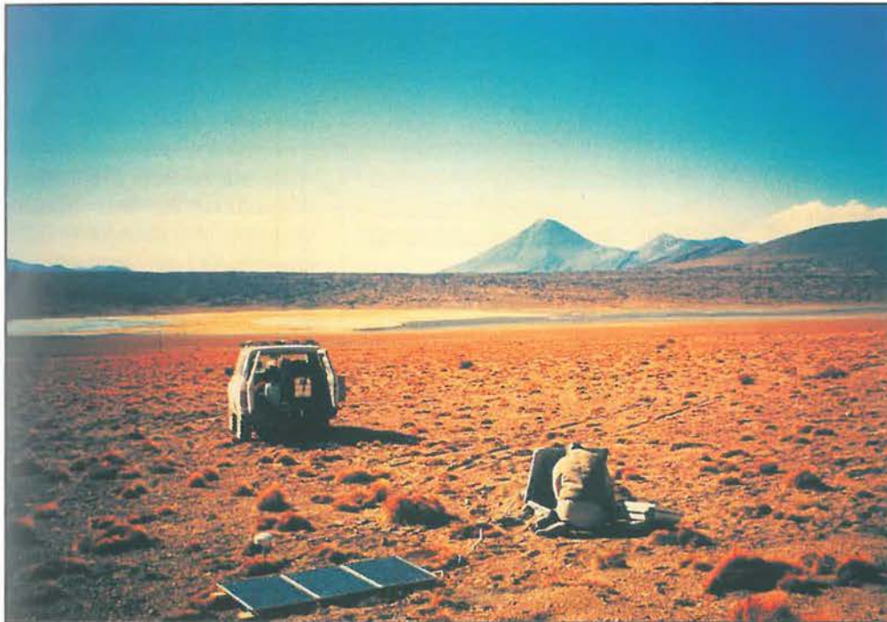
Abb. 1: Wartungsarbeiten an einer MT-Station in der Westkordillere (ca. 4000 m über N. N.), während der Meßkampagne im Herbst 1993. Die im Vordergrund stehenden Solarpanels und die große Speicherkapazität der Apparaturen erlauben es, über 5 Tage kontinuierlich mit 20 Hz bzw. 100 Hz Abtastrate zu registrieren. Dadurch können Sondierungskurven über einen sehr breiten Frequenzbereich bestimmt werden.
