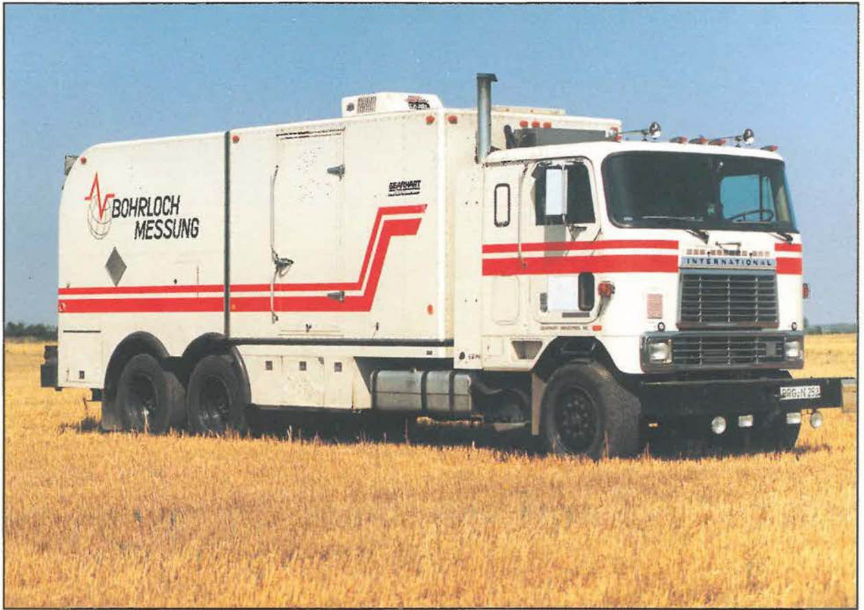
Meßfahrzeug zur Untersuchung von Bohrlöchern (Foto: L. Hannemann)
