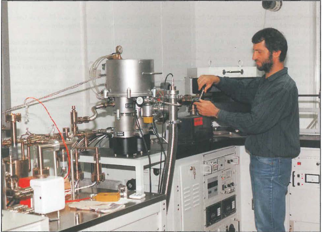
Abb. 2: Sektorfeld-Isotopenmassenspektrometer mit Gasseparations- und Reinigungsanlage (links), Tieftemperaturkryostat (Mitte), Trennmagnet (halb verdeckt) und Detektoreinheit (rechts)
