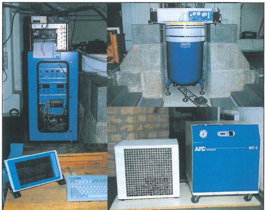
Abb. 15: Komponenten des SLG links: Steuerelektronik und Meßwerterfassung, Analogregistrierung, Meßelektronik für He-Level rechts: Meßpeiler mit Dewar, in dem sich die Gravity Sensing Unit befindet und Neigungskompensation links unten: Monitor und Tastatur rechts unten: Coolpack und Kompressor
