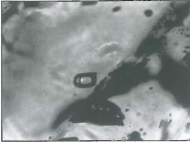
Abb. 7: Zweiphaseneinschluß in Wolframit (Pechtelgrün). Einschlußgröße ca. 25 µm (IR-Aufnahme)
