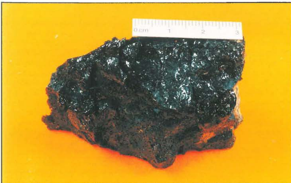
Abb. 4 (unten): Ozeanbodenbasalt von einem mittelozeanischen Rücken aus 2500 m Wassertiefe mit der typischen glasartigen Kruste. Die zahlreichen Gasblasen im Inneren der Probe sind überwiegend mit Kohlendioxid, Stickstoff und Edelgasen gefüllt.
