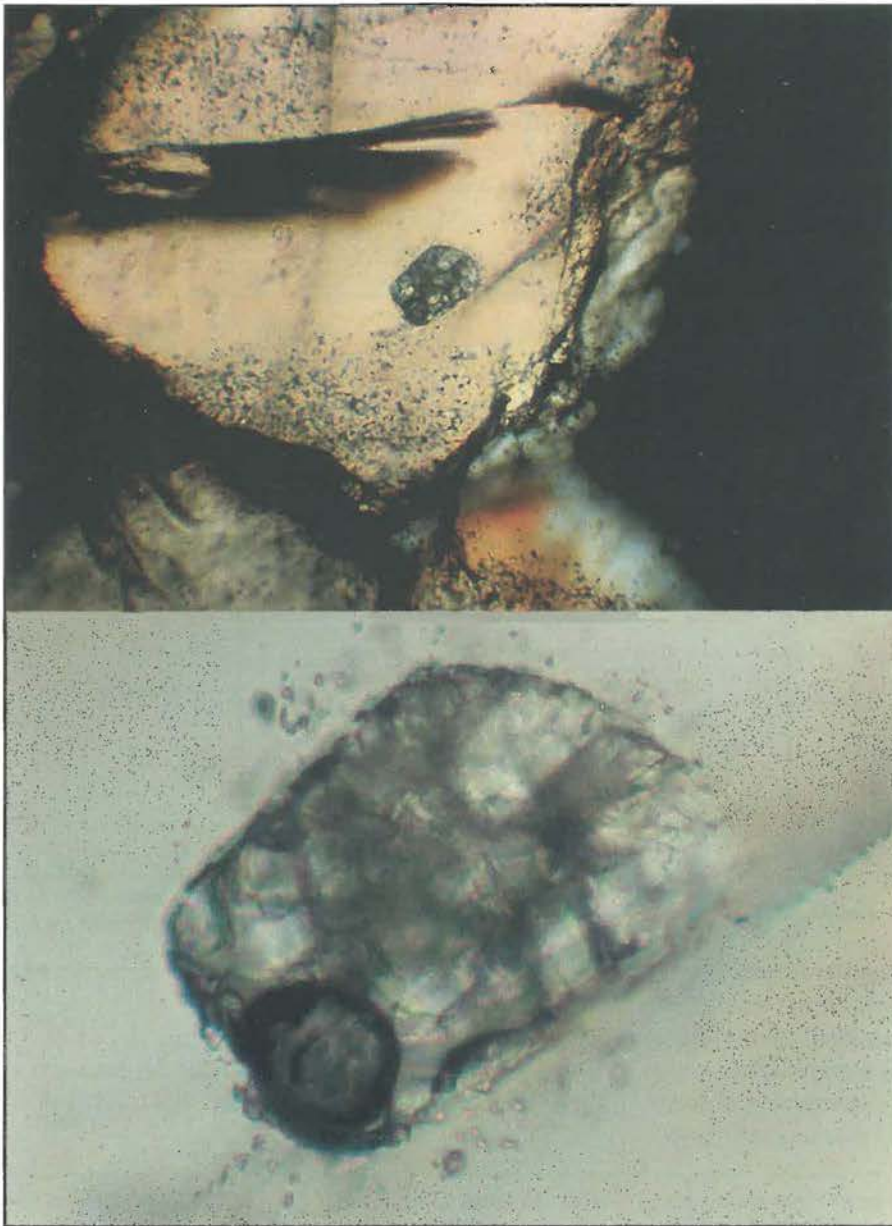
Abb 14: Schmelzeinschluß im Quarz eines Granits (Eibenstocker Massiv/Westerzgebirge)
