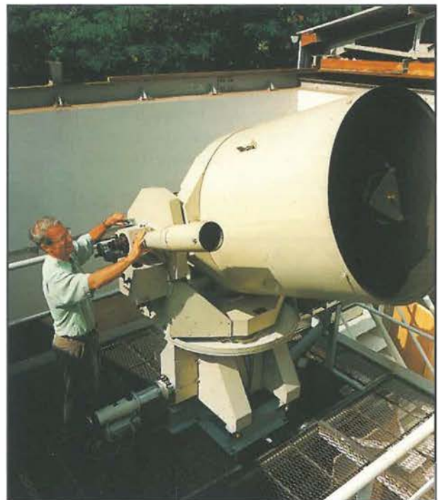
Abb. 6: Ansicht des Sendeempfangsteleskops der Satelliten-Entfernungsmeinrichtung des GFZ. Das Verfahren beruht auf der Laufzeitmessung von Lichtimpulsen mit einer Impulsdauer von ca. 50 ps, wobei eine Genauigkeit von etwa 1 cm erreicht wird.
