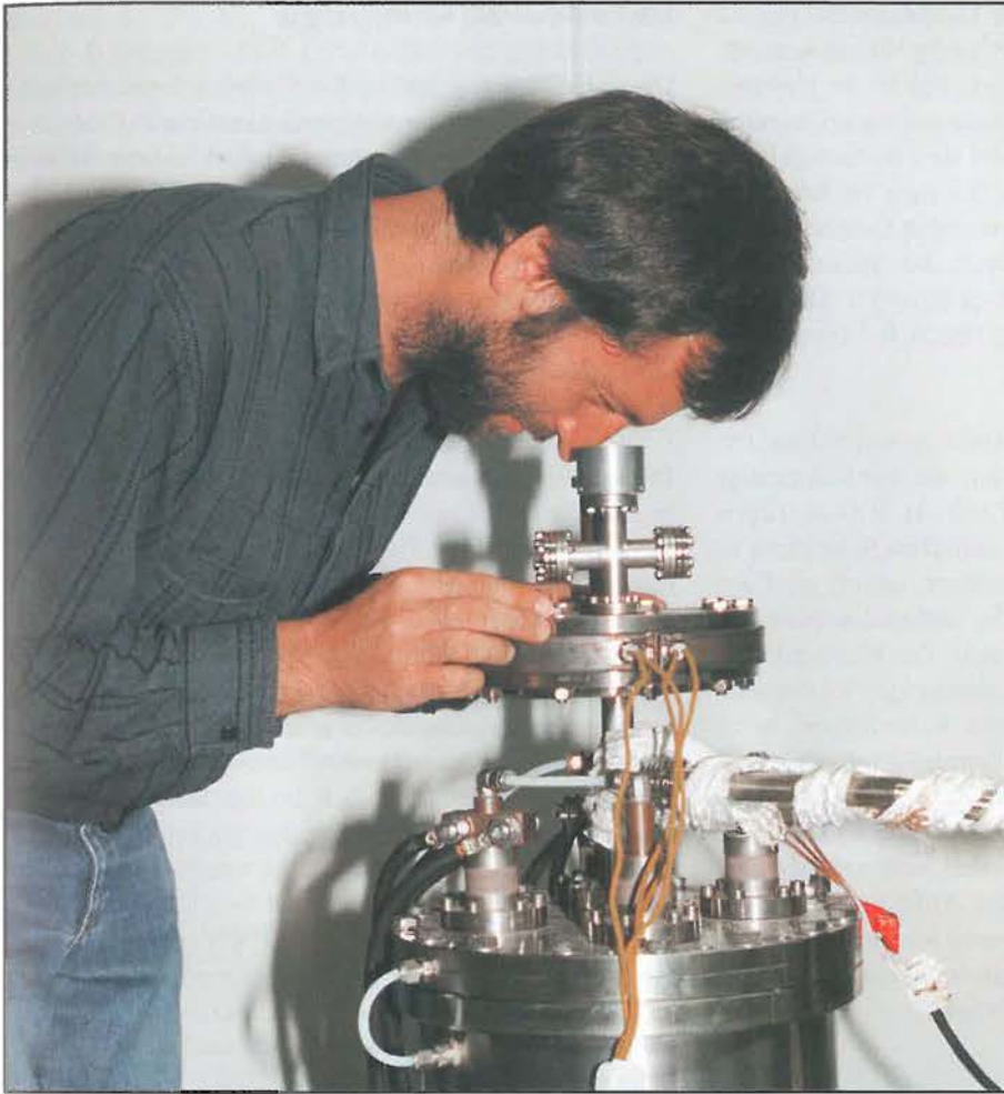
Abb. 3 (oben): Hochvakuum-Ofen zum Entgasen fester Proben bei Temperaturen bis zu 2000 °C mit 10fach-Probenwechsler
