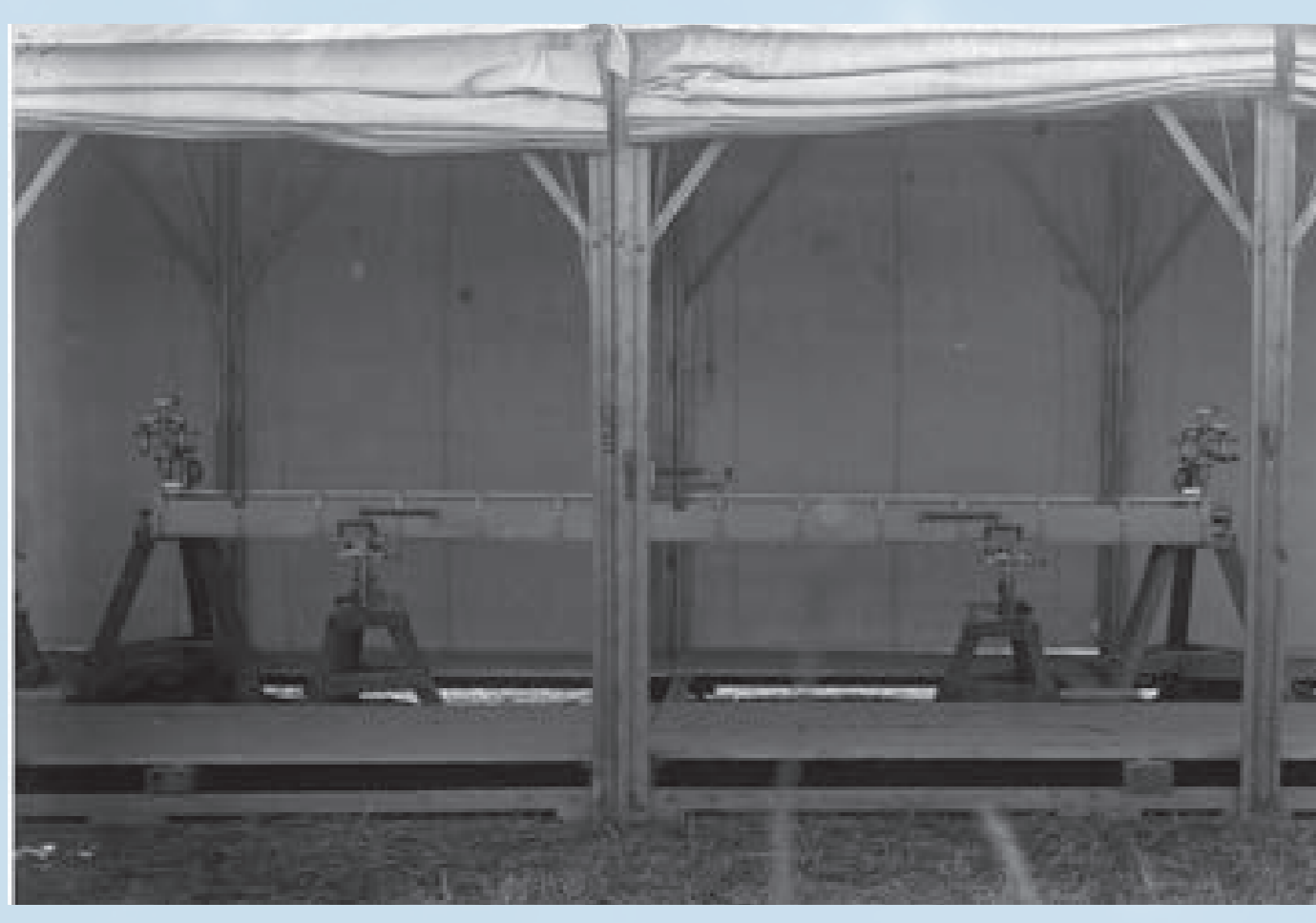
Messaufbau des Brunnerschen Basisapparates mit den Basismikrometern mit Ablotfernrohr (außen) und den Stangenlagern (innen) sowie der originalen Stange von 4m Länge. Measurement setup of Brunner's Base apparatus with the basis micrometers with plumbing telescope (outside) and the rod mountings (inside) as well as the original rod of 4m length
