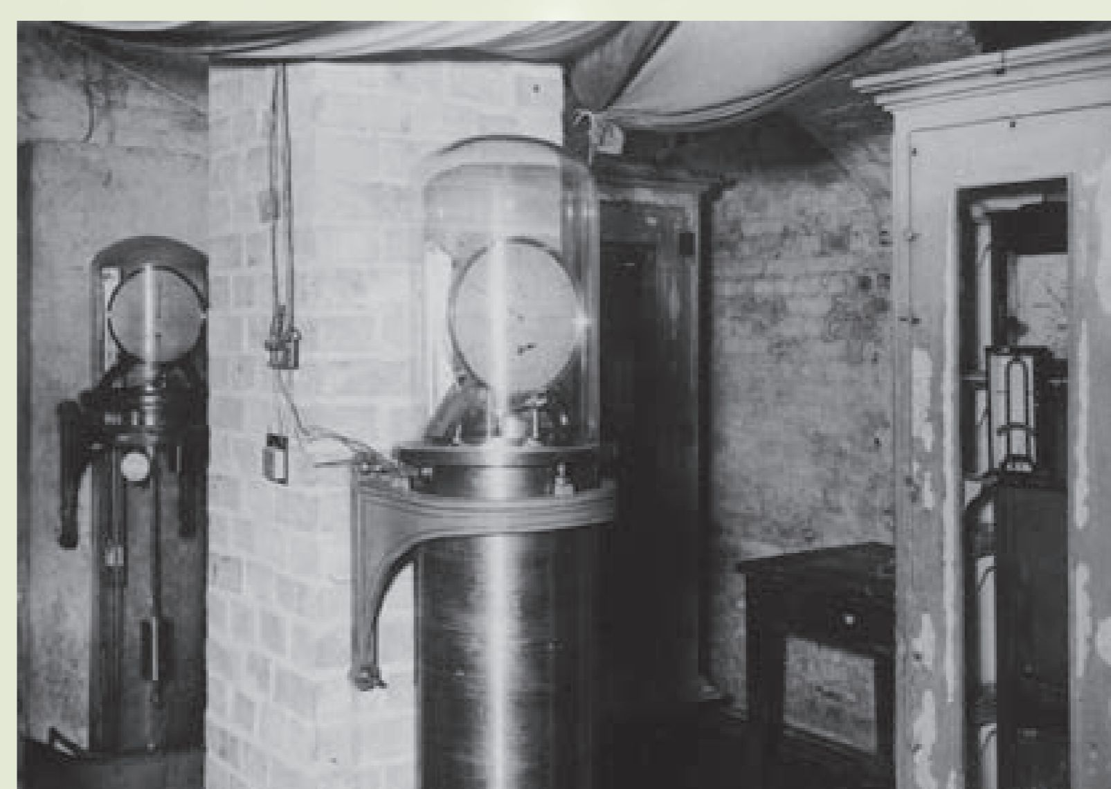
Die Pendeluhr des Institutes arbeiteten unter möglichst gleichbleibenden Umgebungsbedingungen. Ihre Zeitanzeige wird protokolliert und die Ganggenauigkeit ausgewertet. The clocks of the institute worked under environmental conditions that were as constant as possible. The displayed time was logged and the timing inaccuracy was analysed.
