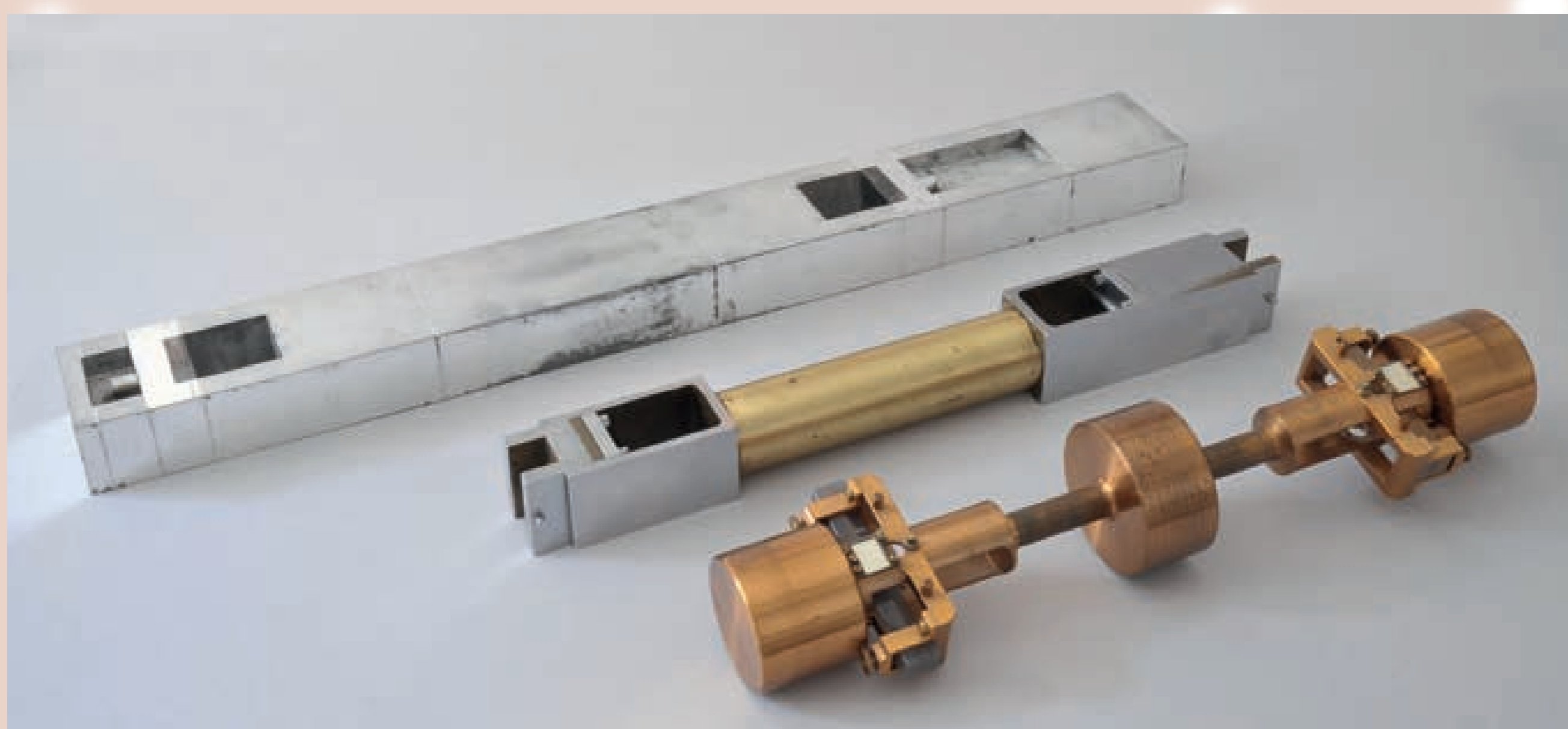
Reversionspendel zur Absolutermittlung der Schwere gibt es in verschiedenen Formen und Materialien, gemeinsam ist ihnen die Existenz von zwei Aufhängpunkten. Reversion pendulums for the absolute determination of gravity exist in different shapes and materials, what they have in common is their two suspension points.
