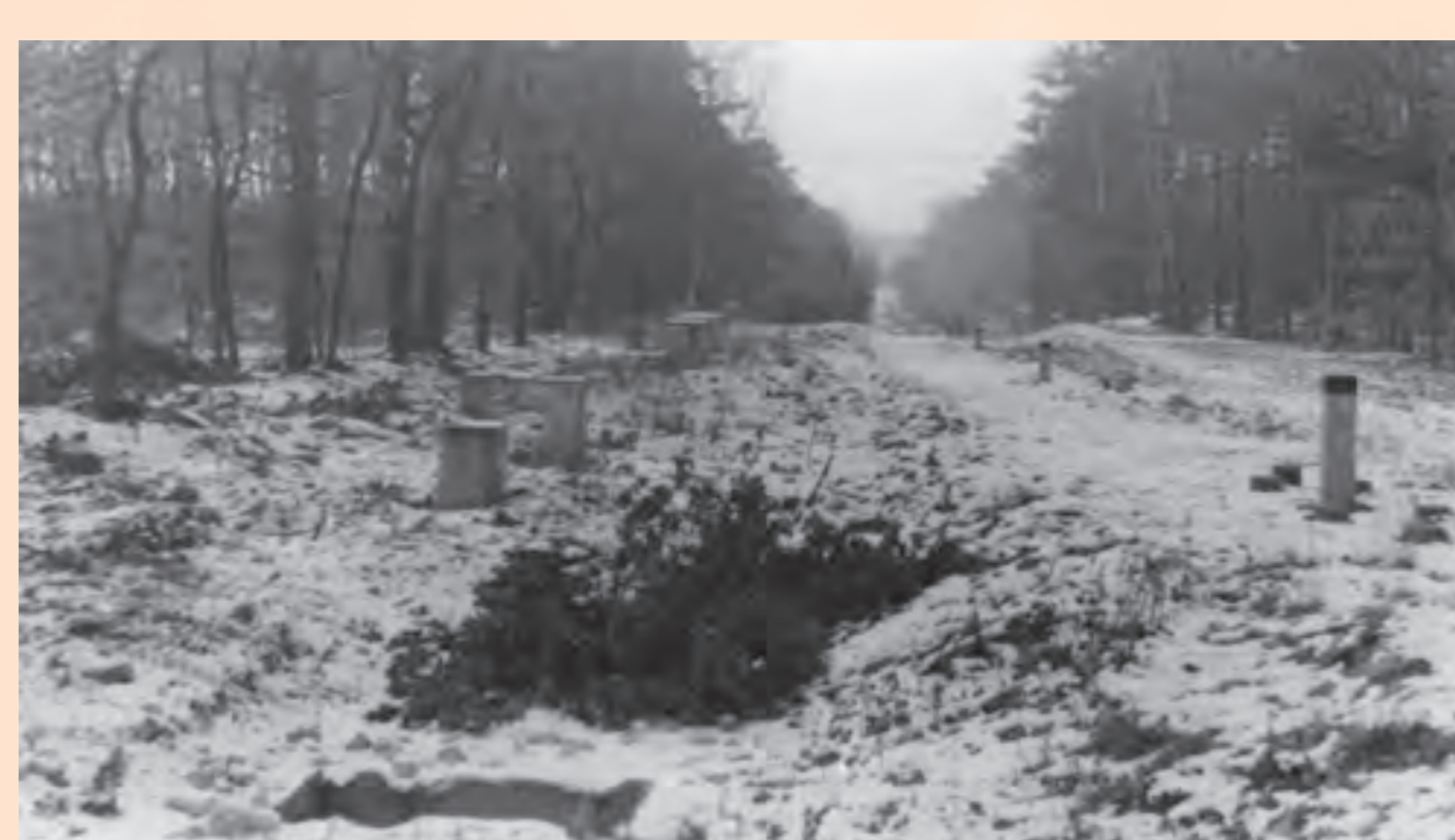
Die 960m lange Eichstrecke mit Vermarkungen im Abstand von 24m. Die Südhälfte im Hintergrund ist nahezu horizontal und damit gut für Eichmessungen nach internationalem Standard geeignet. The 960m long calibration track with measuring marks at distances of 24m. The southern half in the background is almost horizontal and thus well suited for calibration measurements according to international standards.
