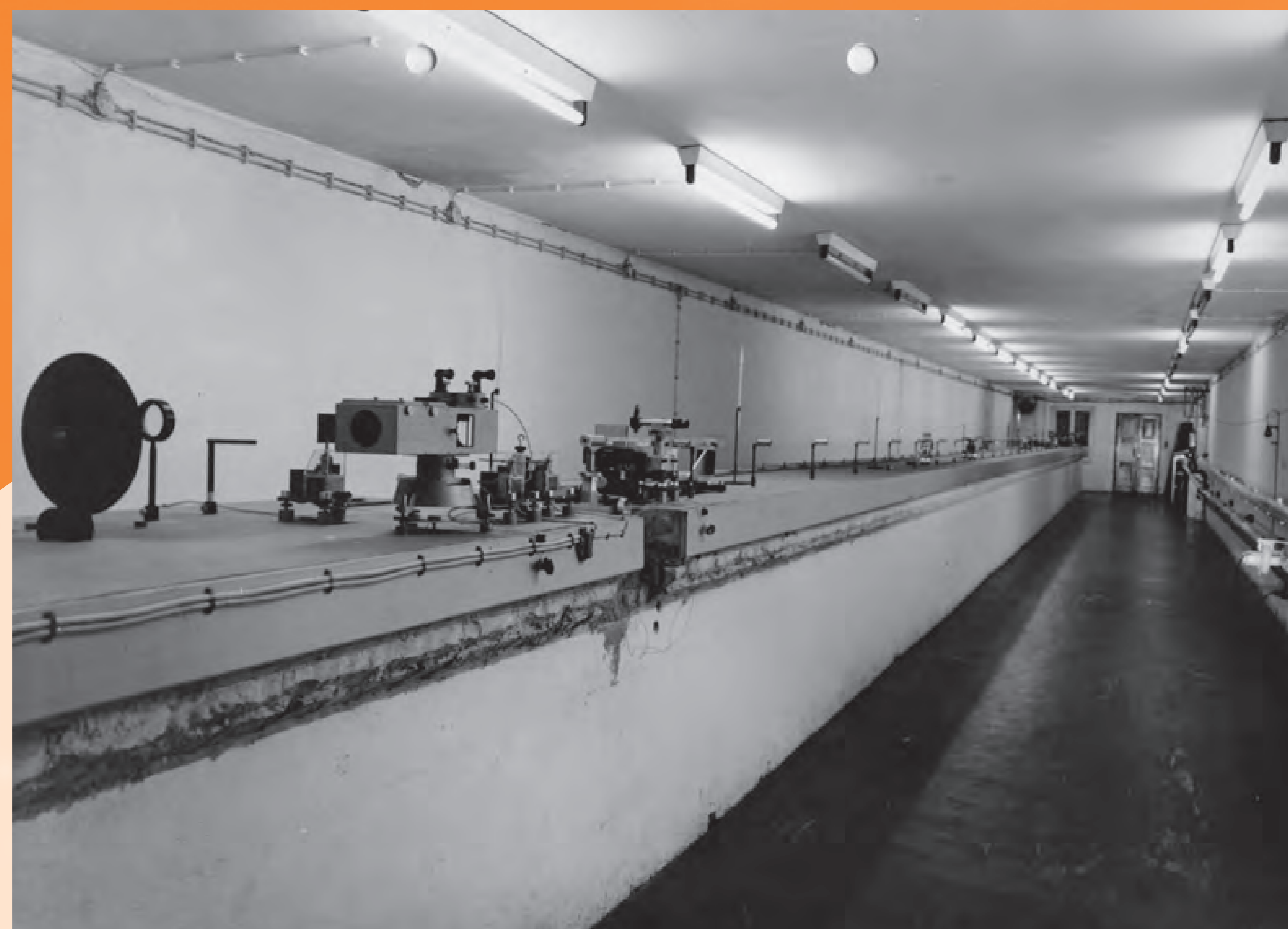
Der 24-m-Interferenzkomparator dient der Eichung von 24m-Invarmessdrähten. Die Gesamtlänge lässt sich mit einer Unsicherheit von 8\mu\text{m} reproduzieren. The 24m interference comparator is used to calibrate 24m invar measuring wires. The total length can be reproduced with an uncertainty of 8\mu\text{m} .
