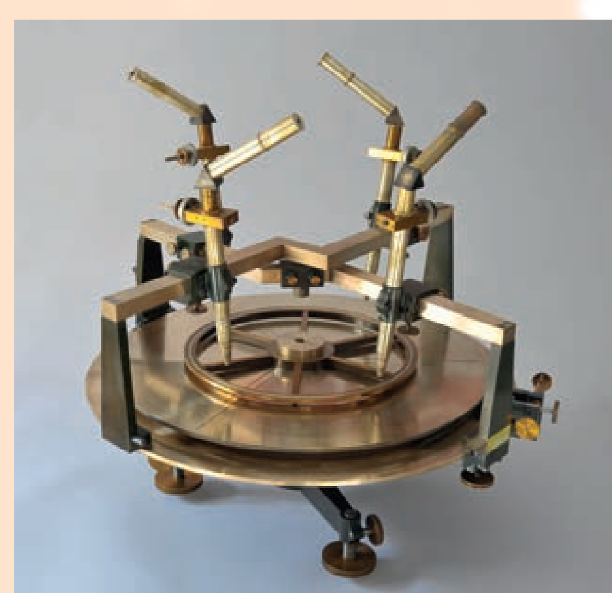
Der Teilkreisprüfer von Wanschaff ermöglicht die Kontrolle der Lagerichtigkeit der Kreisteilungen zur Ablesung von Winkeln. The pitch circle gauge by Wanschaff allows the correct positioning of the circle graduations to be checked for reading off angles.
