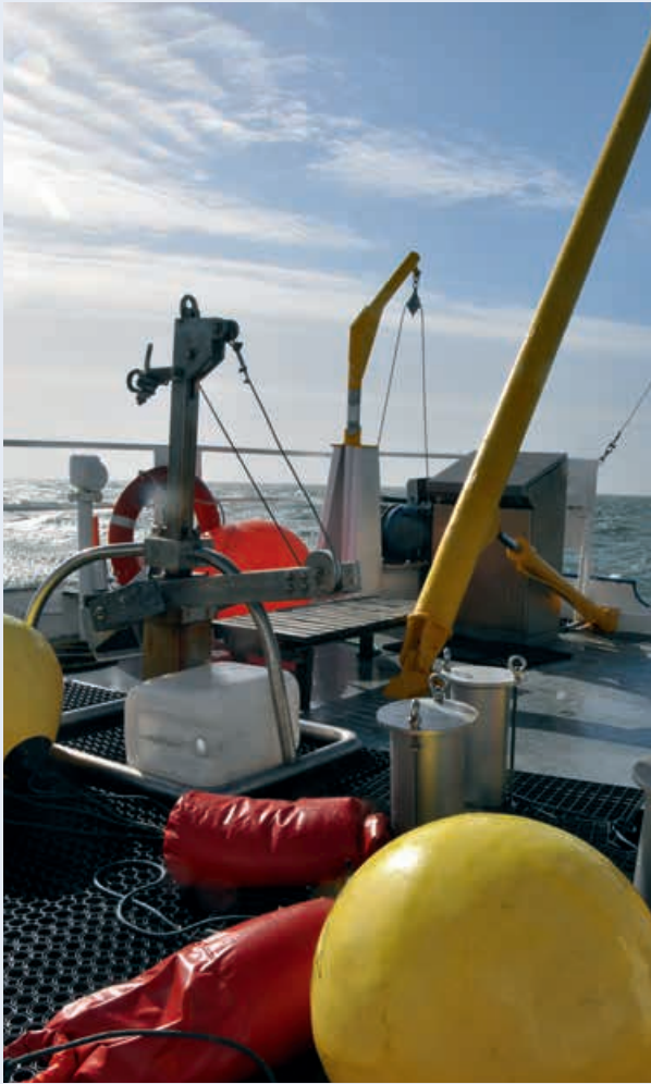
Abb. 4: Einsatz neuerartiger Flachwasser-Seismometer (S-OBS) zur Erforschung des submarinen Untergrunds. Links: Ausbringen der Instrumente bei einem Test in der deutschen Nordsee mit dem AWI-Forschungsschiff „Mya“ (S-OBS sind die Metallzylinder, zusammen mit Ankergewicht (rote Beutel) und gelber Boje) (Foto: C. Haberland, GFZ). Rechts: Ergebnisse des Messeinsatzes in der sibirischen Arktis (Laptevsee), bei dem die Tiefenlage und Erstreckung des submarinen Permafrosts ermittelt wurde (Overduin et al., 2014; Wiederverwendung der Abbildung rechts mit freundlicher Genehmigung des Verlags John Wiley and Sons)
