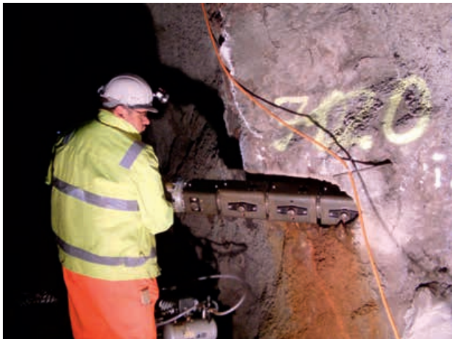
Abb. 3: Test einer SPWD-Sonde in der Eisenerzmine von Kiruna, Schweden. Links: Einbau der Sonde in die Erkundungsbohrung. Rechts: Die SPWD-Sonde, bestehend aus seismischer Sektion (Vordergrund) und Elektronik-Sektion für die Signalerzeugung, Datenaufzeichnung und Übertragung zur Oberfläche (Hintergrund; Foto: R. Giese, GFZ)
