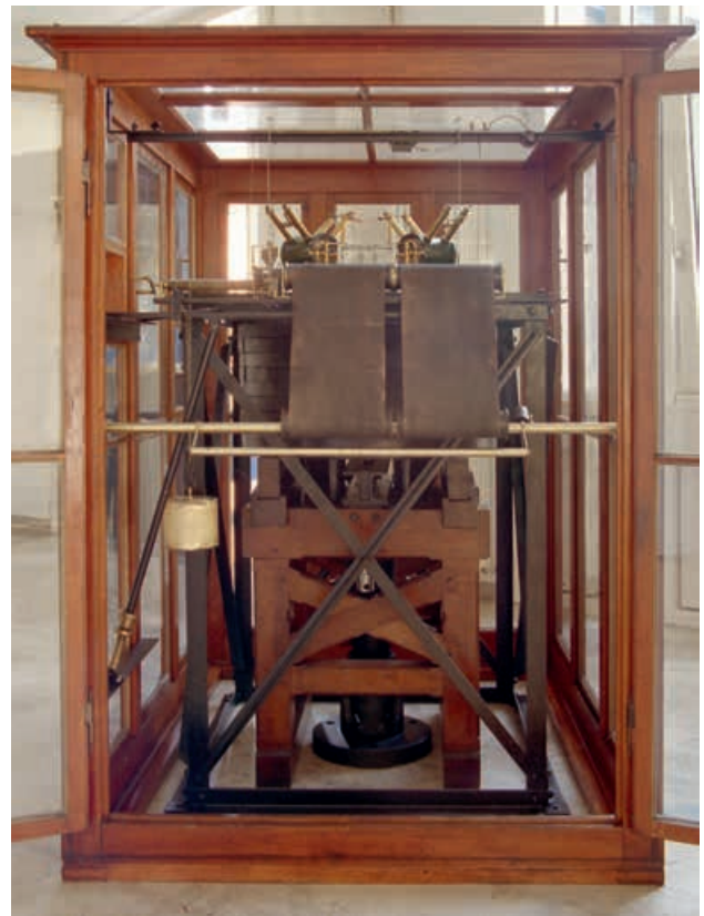
Abb. 1: Der im Foyer des GFZ ausgestellte Horizontalseismograph von Emil Wiechert war in Potsdam von 1903 bis 1954 im Einsatz (Foto: E. Gantz, GFZ)
