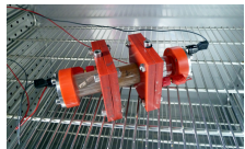
Abb. 1: Messzelle mit Elbsandsteinprobe.
