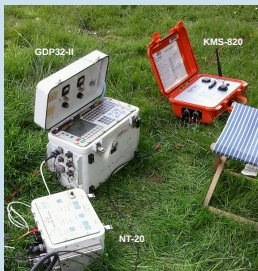
Abb. 1: Foto der verwendeten Messgeräte. NT-20 (vorne), GDP32-II von Zonge Engineering und KMS-820 von KMS Technologies (rechts)
