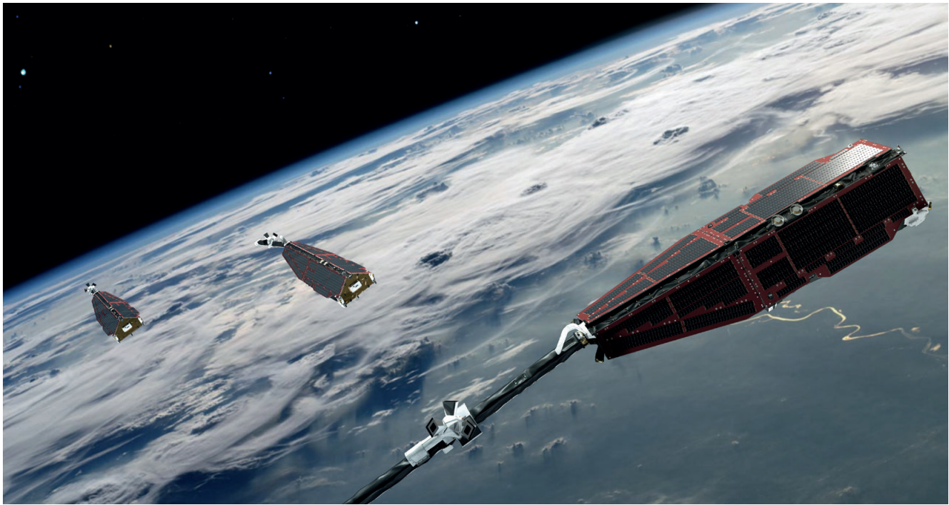
Das Satellitentrio SWARM empfängt Signale von bis zu acht GPS-Satelliten gleichzeitig. (Illustration: ESA/AOES Medialab)
