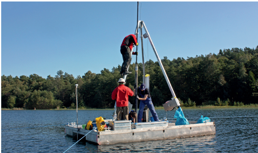
Forscherinnen und Forscher des GFZ und des virtuellen deutsch-polnischen Instituts ICLEA nehmen Bohrkern aus dem Sediment des Fürstenseer Sees. (Foto: A. Brauer, GFZ)
