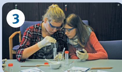
3 Probenvorbereitung: Zuerst müssen die Proben gewogen, zerkleinert (gemörsert) und aufgelöst werden. (Foto: J. Buhk, GFZ)
