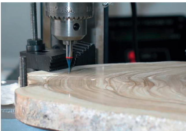
Abb. 5: Parallel zur Wachstumsrichtung aufgeschnittener und polierter Stalagmit aus einer Höhle in Kirgisistan mit feinen Lagen eingespannt in einer Mikrobohranlage (Foto: B. Plessen, GFZ)
