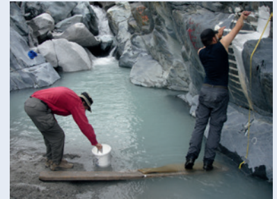
Erosionsraten werden durch Farbanstrich ermittelt (Foto: J. Turowski, GFZ)
