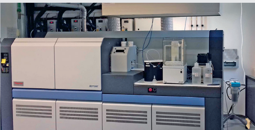
Multikollektor-Massenspektrometer mit induktiv gekoppeltem Plasma Multicollector-Inductively Coupled Plasma Mass Spectrometer (MC-ICP-MS)
