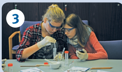
3 Probenvorbereitung: Zuerst müssen die Proben gewogen, zerkleinert (gemörsert) und aufgelöst werden. (Foto: J. Buhk, GFZ)
