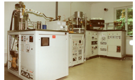
Abb. 3: Edelgasmassenspektrometer mit Hochtemperatur-Ausheizanlage (links) und Gasreinigungsteil (Mitte) in einem klimatisierten Messgeräte Raum in der Baracke A50
