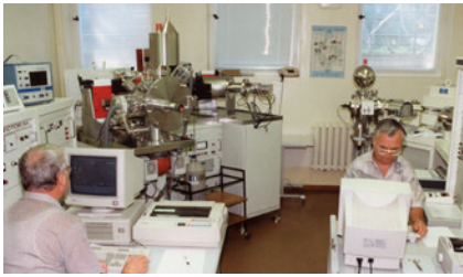
Abb. 4: Unsere beiden ersten Thermionenmassenspektrometer (TIMS) aufgebaut in dafür renovierten und umgebauten klimatisierten Kellerräumen des Gebäudes A43 (heute AWI). Dr. Heinz Gerstenberger am VG Sektor 54 (links) und Gunter Haase am Finnigan MAT 262 – viel enger ging es kaum!
