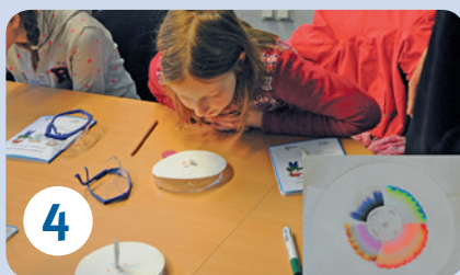
4 Probenaufbereitung: Mit der Chromatographie werden einzelne Stoffe aus einem Stoffgemisch getrennt. (Foto: R. Pokharel, GFZ)
