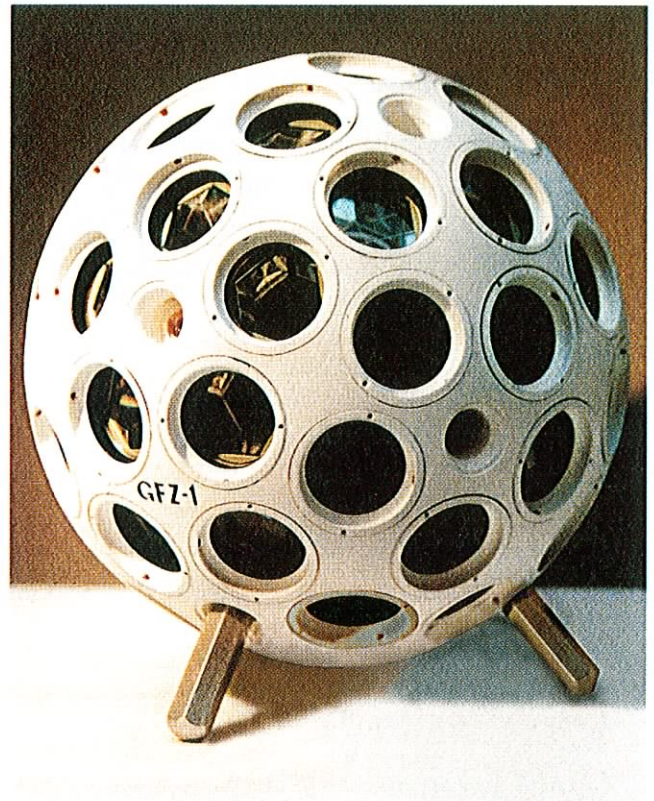
GFZ-1 ist ein passiver, kugelförmiger Satellit, der ohne teure Bauteile für Stromversorgung, Telemetrie oder Antrieb auskommt.
