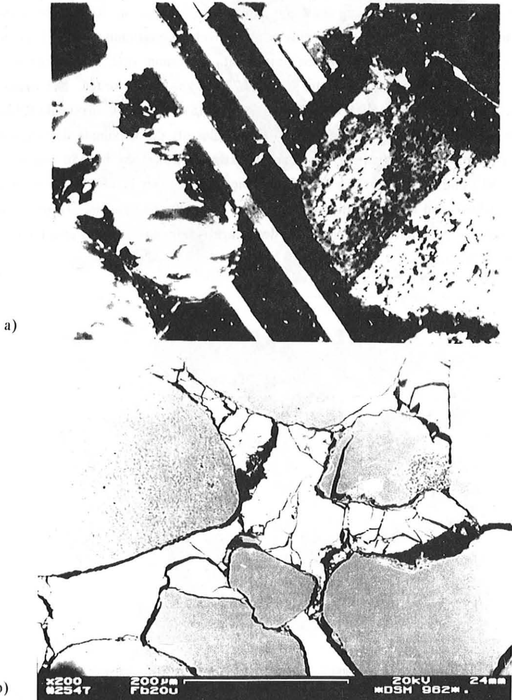
Abb. 4.49: (a) Lichtmikroskopische Aufnahme von abgescherten Kalzitzwillingen. (b) Rasterelektronenmikroskopische Aufnahme von "zerrissenem" Kalzitzement und nahezu intakten Quarzkörnern. Mittlerer Korndurchmesser in beiden Bildern 0.2 mm.
