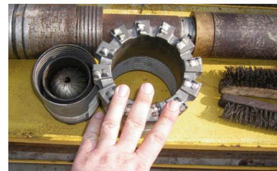
Diese Spezialanfertigung fräst durch die härteren Salzlagen. Der Sedimentkern wird dann im „CoreCatcher“ an die Oberfläche befördert.
