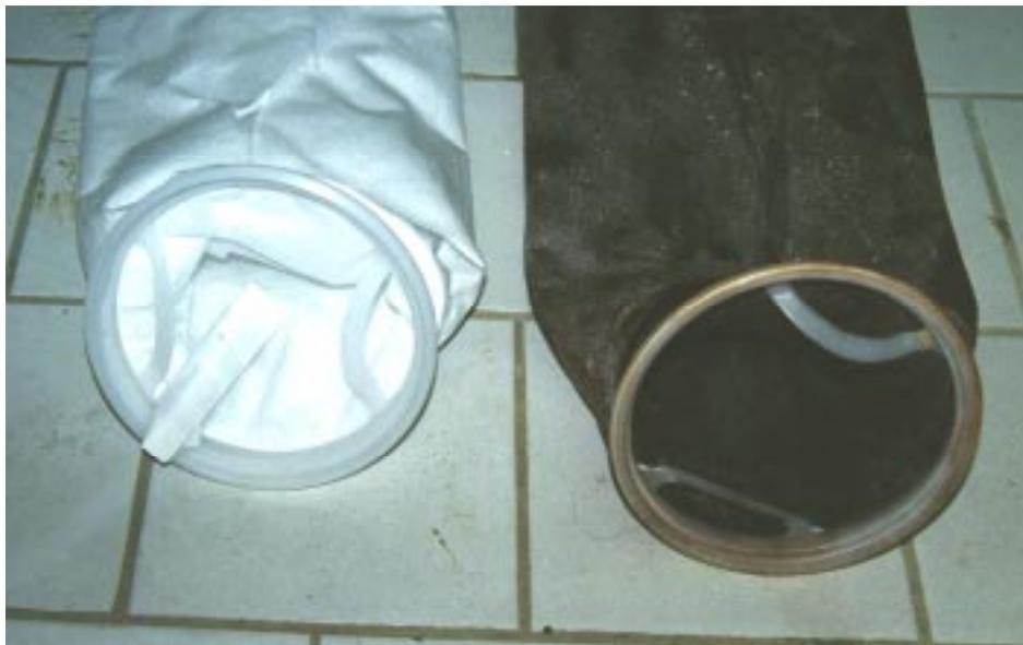
**Abbildung 7-8:** Filter vor und nach der Slopwasserverpressung
