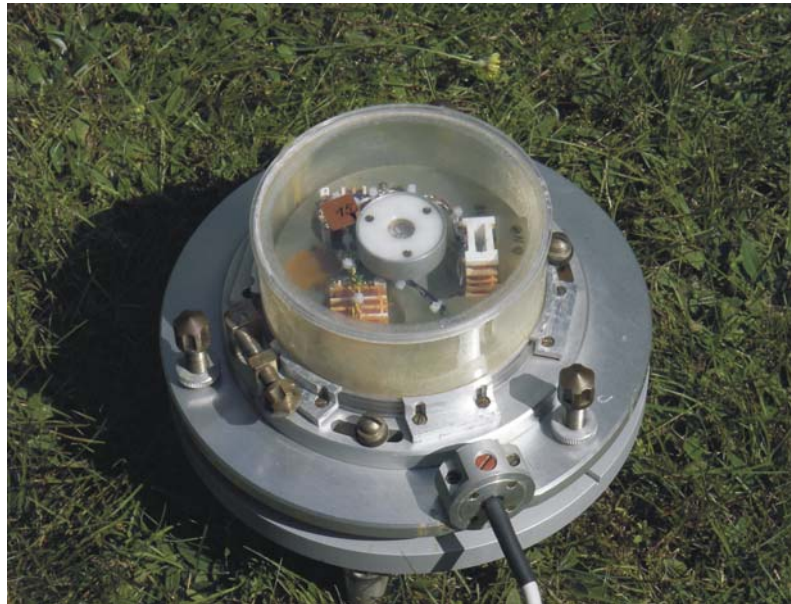
Abb. 1 MAGSON 3 axial fluxgate Magnetometer Baujahr 1993
