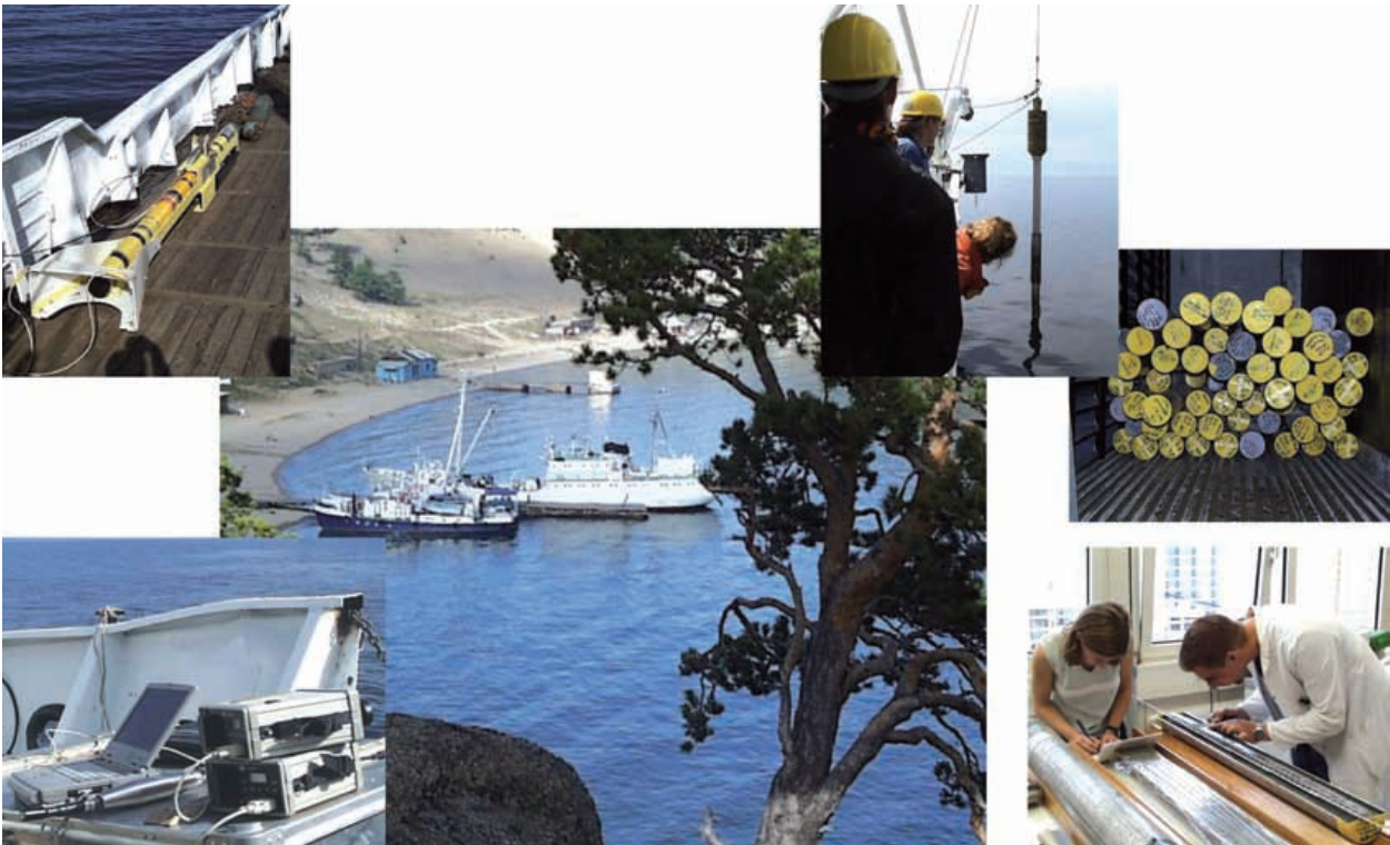
Abb. 5: Aktivitäten im Gelände 2001 bis 2003: Side-scan-sonar SONIC 3 der Kollegen aus St. Petersburg (oben links), Geländespektrometer GER (unten links), Bekernung mit modifiziertem Kullenberglot (Prof. Meischner, Universität Göttingen) (oben rechts). 70 m Sedimentkerne gestapelt im Container (Mitte rechts). Susanne Fietz und Xavier Boes bei der Kernbeschreibung und Beprobung am GFZ Potsdam (unten rechts). In der Bildmitte das russische Forschungsschiff „Vereshagin“ (Fotos: J. Klump, GFZ).
