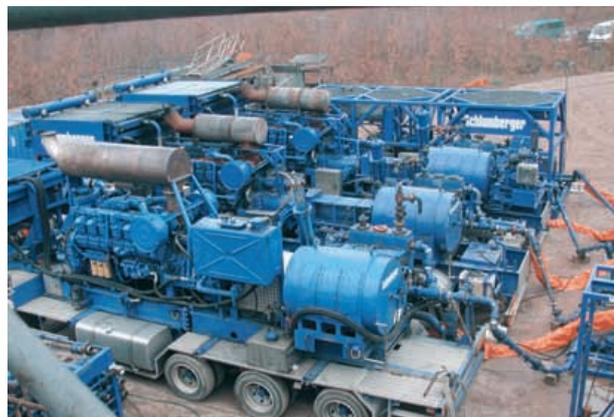
**Abb. 3:** Hochleistungspumpen für den massiven Wasser-frac in der Geothermie-Forschungsbohrung Groß Schönebeck bei Berlin, November 2003 (Foto: E. Huenges, GFZ)
