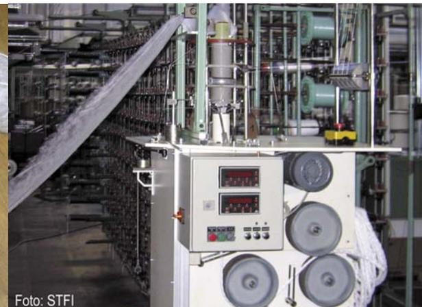
KEMAFIL®-Maschine mit Füllereinrichtung
