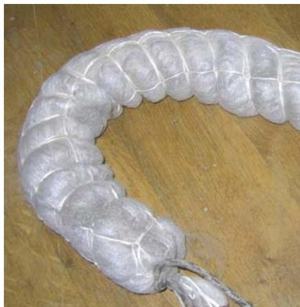
Mit mineralischen Bestandteilen gefüllte KEMAFIL®-Struktur
