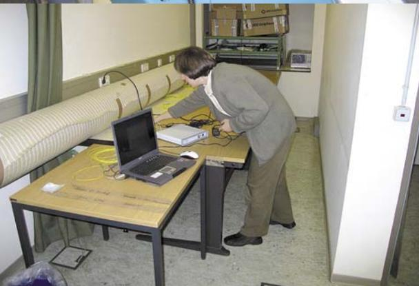
Die gemessene Deformation der Textilstruktur – und damit die Deichverformung – wird in Messstationen, die einige Kilometer entfernt voneinander installiert werden können, erfasst und registriert.
