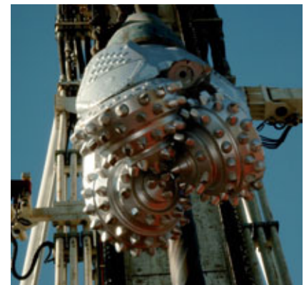
Abb. 6 Rollenmeißel, Geothermiebohrung Groß Schönebeck 4/05
