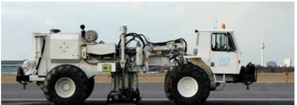
Abbildung 2: Seismischer Vibrator (Foto K. Erbas, GFZ)
