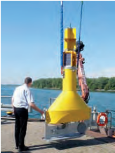
Abbildung 3 Einsetzen einer Messtonne mit Trübungssensor in der Ems bei Herbrum
