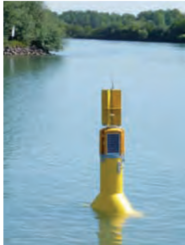
Abbildung 3 Einsetzen einer Messtonne mit Trübungssensor in der Ems bei Herbrum
