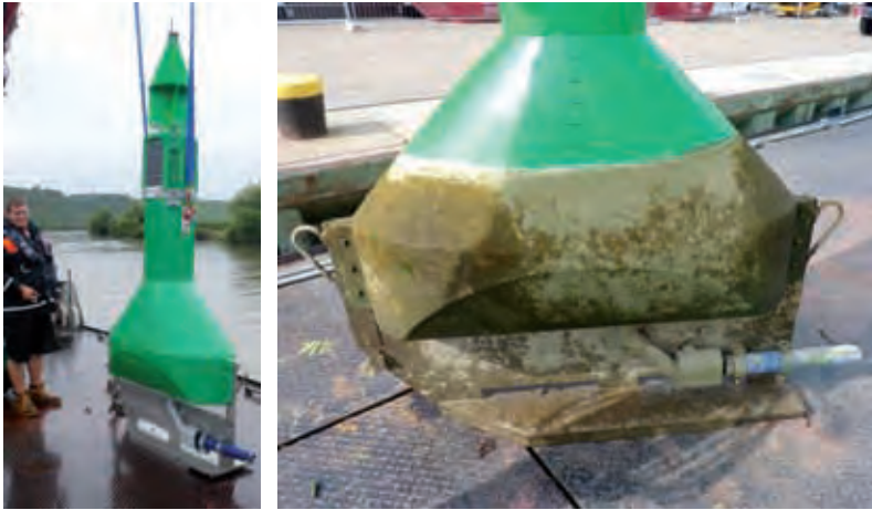
Abbildung 6 Tonne mit Strömungsmesssensor vor dem Einsetzen im Neckar bei Lauffen und nach acht Monaten Betrieb
