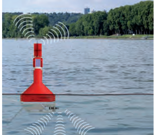
Fahrwassertonne zur kontinuierlichen Messung von Wassertiefe und Fließgeschwindigkeit als autarke Messstation mit Datenfernübertragung
