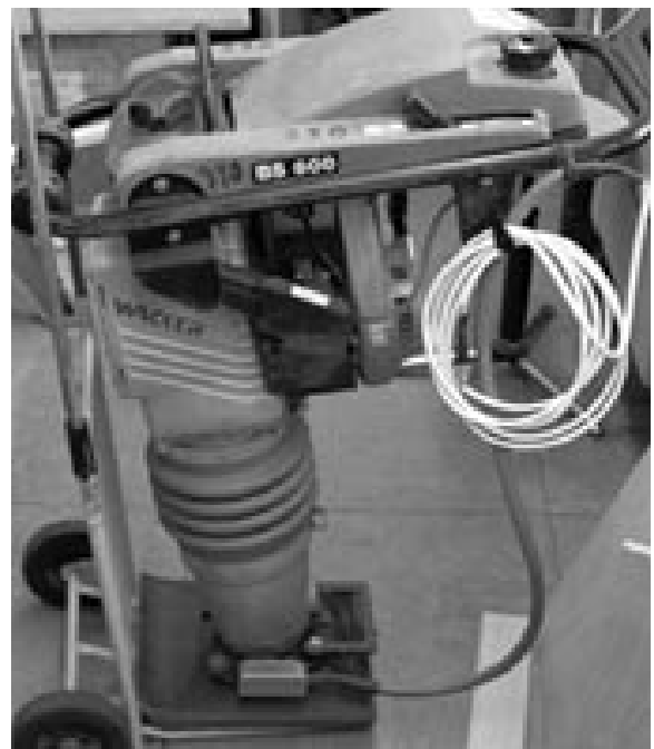
Abbildung 1: Wacker BS 600 Vibrationsstampfer mit angeschlossener Sensorbox.
