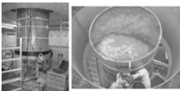
Abbildung 1: Blick auf das auf Stützen platzierte Lysimeter in der Lysimeterhalle (links). Vogelperspektivische Aufnahme des teilbewässerten Lysimeters mit von Hand platzierter Georadarantenne (rechts).
