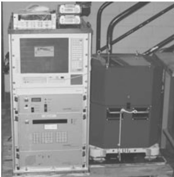
Abbildung 1: Das KSS31M System mit Sensor und Kreiselstisch (rechts) und Steuerungselektronik und Stromversorgung (links).
