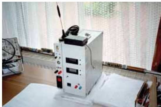
Abbildung 1: Übertageeinschub der Monitoringeinheit mit GPS-Terminal (im Hintergrund ein Sondenteil)
