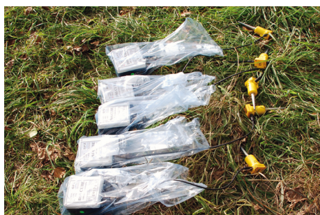
Unscheinbar, aber hocheffizient: Die Datenlogger DSS-Cube mit den jeweiligen Geophonen (siehe Infokasten)
