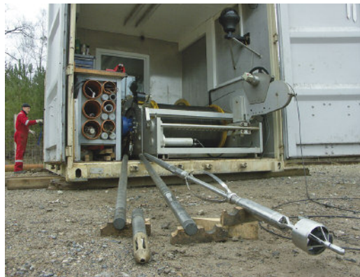
Abbildung 2 Hybrides Bohrlochmesssystem zur Durchführung von kombinierter Messung mit elektrischen und faseroptischen Sensoren.
