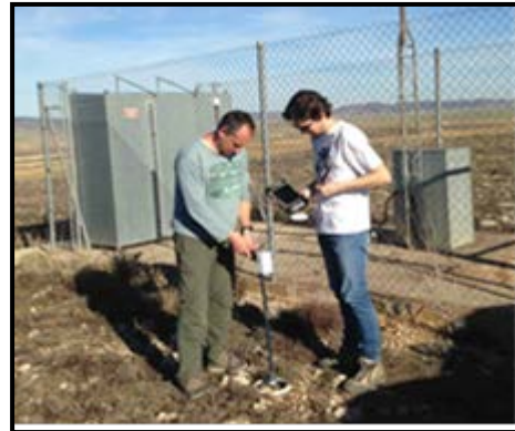
Figura 1: Izq: Muestra de suelo y Agl analizadas en laboratorio. Dcha: Medidas de susceptibilidad con el Bartington en campo.
