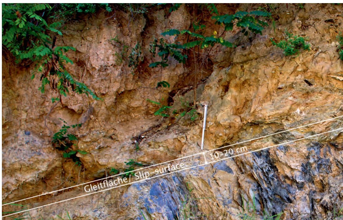
Abb. 5: Hangrutsch im Süden der Provinz Gansu (Zentralchina), der durch langandauernde Kriechprozesse gekennzeichnet ist. Deutlich trennt die Gleitfläche anstehendes Gestein (Phyllit) vom darüberliegenden Löss (Foto: M. Schäbitz, GFZ).
