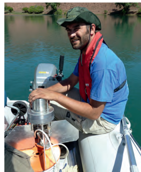
Feldkampagne im Juni 2012 auf dem Ak-Köl-See in Zentralkirgisistan. Stefan Lauterbach arbeitet mit einem Kurzkerngerät, mit dem Sedimentkerne aus dem Seeboden gezogen werden (Foto: J. Mingram, GFZ).
