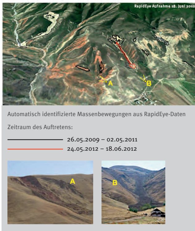
Abb. 2: Beispielhaftes Ergebnis der automatischen Identifizierung von Massenbewegungen. Die Grenzen der detektierten Hangrutschobjekte sind in schwarz und rot dargestellt und der perspektivischen Satellitenbildansicht überlagert. Die Punkte A und B markieren den Standort und die Blickrichtung der Geländefotos (Fotos: R. Behling, GFZ).
