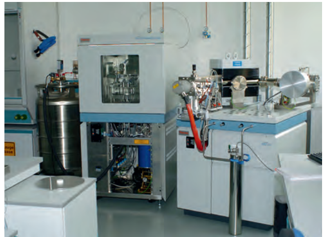
Abb. 11: Vertikalbohrer zur hochauflösenden Beprobung ( <100\ \mu\text{m} ) von Speläothemen für die Messung der stabilen Isotopenverhältnisse des Kohlen- und Sauerstoffs (links), Karbonatauflösungseinheit KIEL IV und Isotopenverhältnis-Massenspektrometer MAT 253 (rechts) (Fotos: B. Plessen, GFZ)
