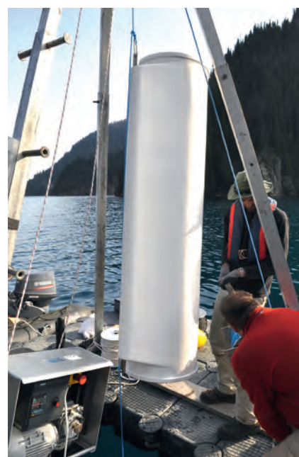
Abb. 2: Ausbringen einer automatischen Sedimentfalle (Technicap PPS 3/3) mit 0,125 m 2 Auffangöffnung auf dem Sary-Chelek (Foto: J. Mingram, GFZ)
