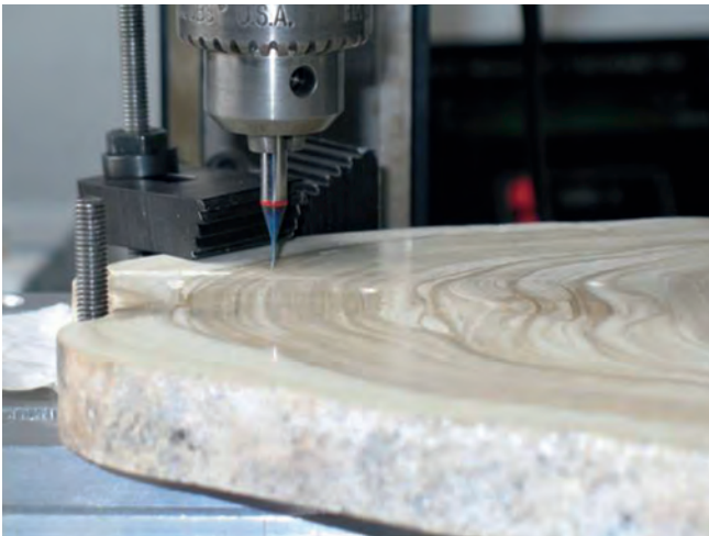
Abb. 11: Vertikalbohrer zur hochauflösenden Beprobung ( <100\ \mu\text{m} ) von Speläothemen für die Messung der stabilen Isotopenverhältnisse des Kohlen- und Sauerstoffs (links), Karbonatauflösungseinheit KIEL IV und Isotopenverhältnis-Massenspektrometer MAT 253 (rechts) (Fotos: B. Plessen, GFZ)
