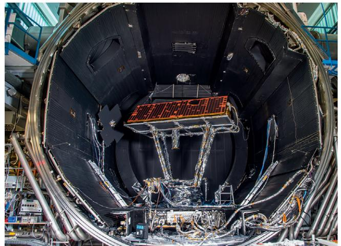
Abb. 2: GRACE-FO-Satellit 1 während des Thermal-Vakuumtests bei der IABG (Airbus Defence and Space GmbH)
