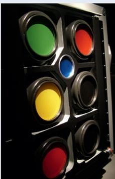
Abb. 2: Multispektralkamera MKF-6 (Foto: Ziko ([https://commons.wikimedia.org/wiki/File:2009-07-21\\_ob\\_22\\_mkf-6\\_multispektralkamera.JPG](https://commons.wikimedia.org/wiki/File:2009-07-21_ob_22_mkf-6_multispektralkamera.JPG)), „2009-07-21 ob 22 mkf-6 multispektralkamera“, <https://creativecommons.org/licenses/by-sa/3.0/legalcode>)
