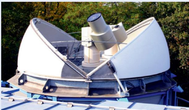
Abb. 5: SLR-Station des GFZ
