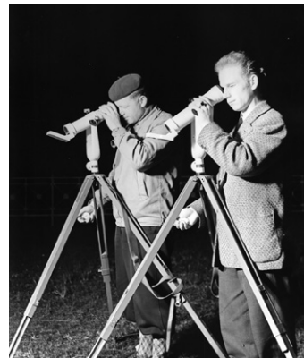
Abb. 1: Vor 60 Jahren – Beginn der Satellitengeodäsie auf dem Telegrafenberg in Potsdam: Bahnvermessung des Sputnik 2 mit AT-1 und Stoppuhr (Foto: V. Kroitzsch)
