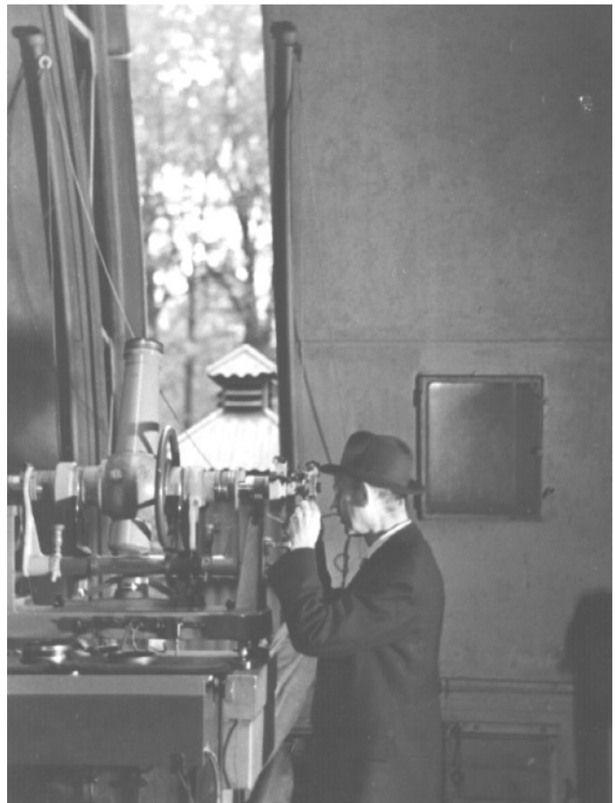
Abb. 12. Durchgangsbeobachtung am Passageinstrument zur astronomischen Zeitbestimmung. Foto: Archiv Dr. Höpfner
