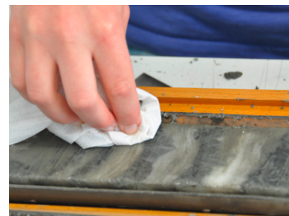
Ein bereits geteilter Kern mit einer laminierten Salzabfolge wird für die Scanner-Analytik präpariert
