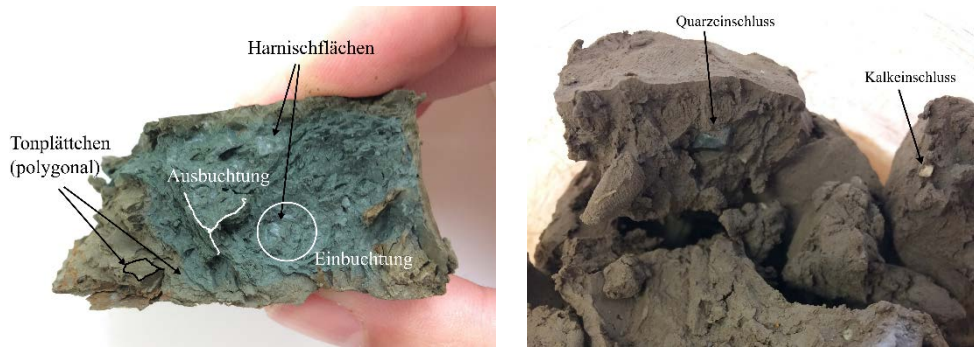
Bild 4. Bruchflächen bei Zugbeanspruchung und natürlichem Wassergehalt Fig. 4. Fracture surface resulting from tensile stresses at natural water content
