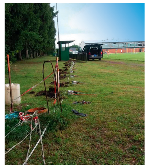
Feldeinsatz zur Beobachtung von Auflösungsprozessen im Untergrund von Münsterdorf. Hier wird die elektrische Leitfähigkeit mit an einer Kette befestigten Elektroden im Bohrloch und an der Erdoberfläche gemessen (Fotos: Krawczyk, GFZ).
