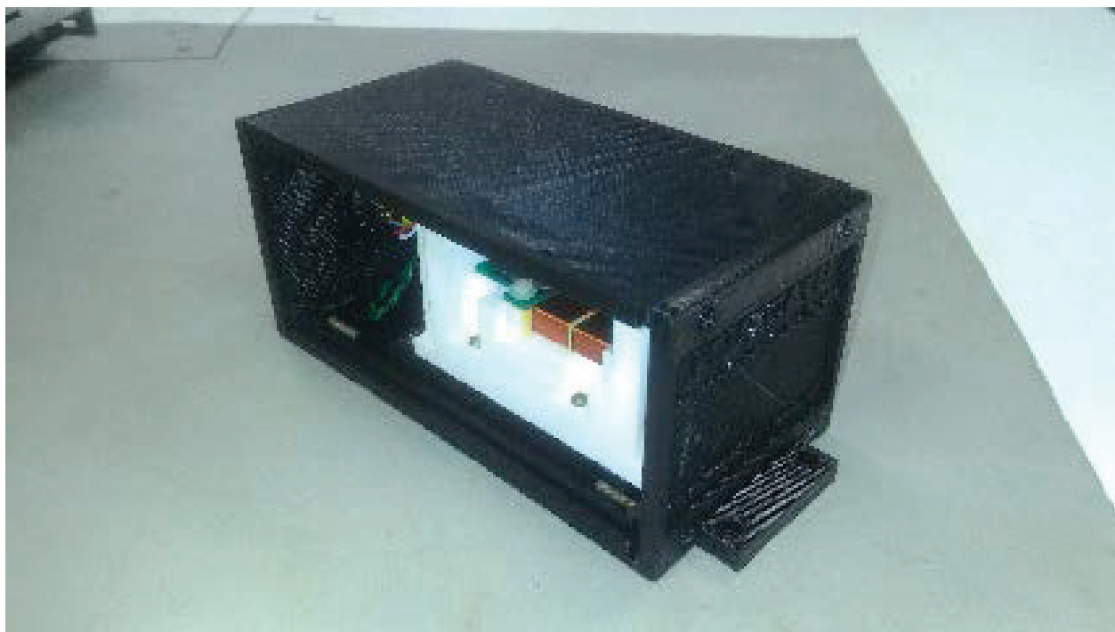
Figura 1 – Protótipo do sensor fluxgate do LDSM para uso em observatórios
