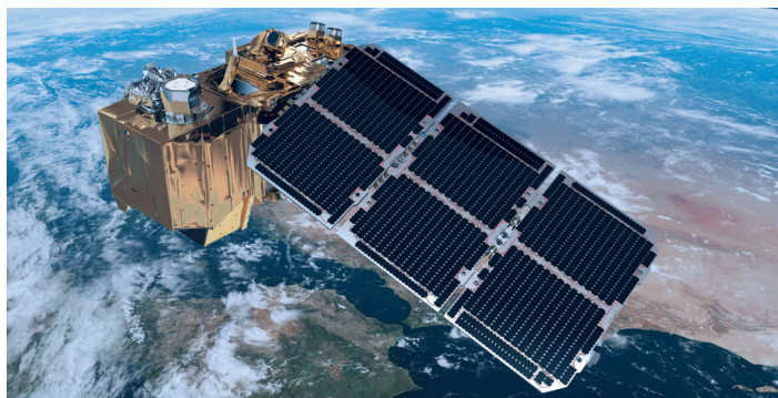
Sentinel-2 trägt hochauflösende multispektrale optische Sensoren zur Überwachung von Vegetationsänderungen für das europäische Umweltbeobachtungsprogramm Copernicus. (Bild: ESA/ATG medialab)
